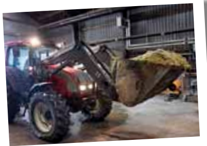
Der Biogas-Traktor von Valtra überzeugte bei der Erledigung von kurzen Alltagsaufgaben. Bei Ladearbeiten von 3 Stunden pro Tag musste der Traktor jeden zweiten Tag betankt werden.
