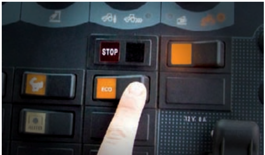
Ein einfacher Schalter kann 10–15 Prozent Kraftstoffersparnis bringen.
